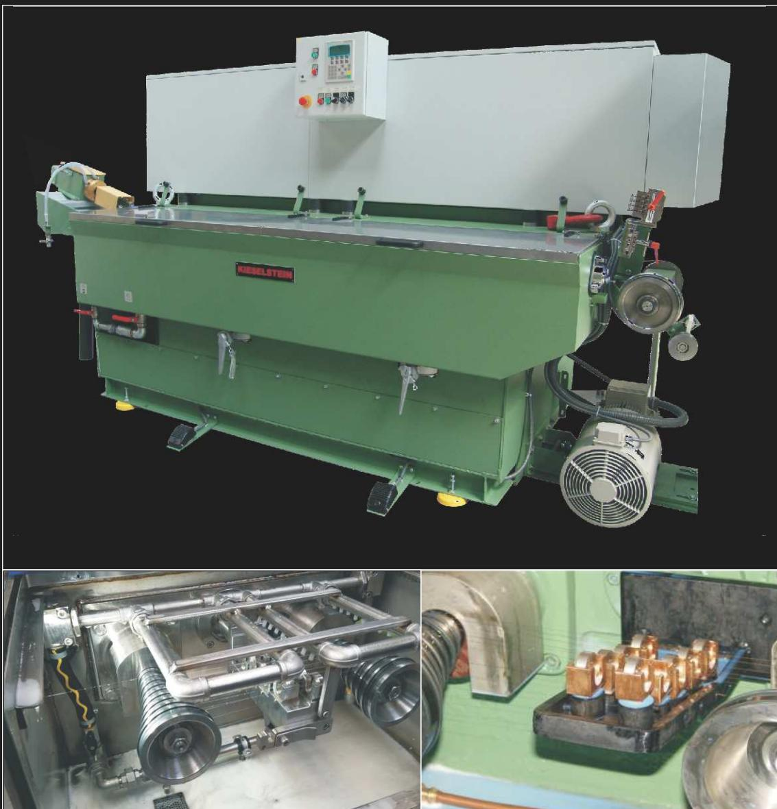
**Nassziehmaschine für hochfeste Stahldrähte und Drähte aus Nichteisenmetallen**
