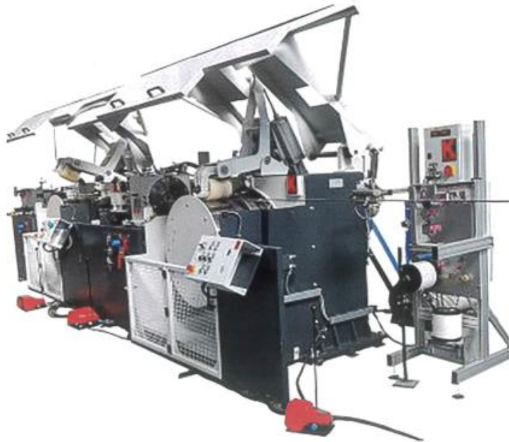
Die so gestaltete Ziehschäleinheit lässt sich nunmehr beliebig in Anlagen integrieren. © Kieselstein
